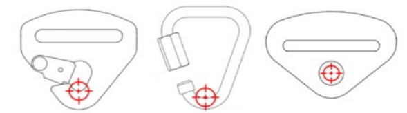
Exemples de points de rotation de l'ancrage de sangle Examples of pivot points of the anchorage of the strap
