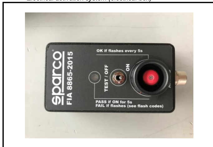
C2-2) Système d'activation électrique (boîtier électrique) Electrical activation system (electrical box)
