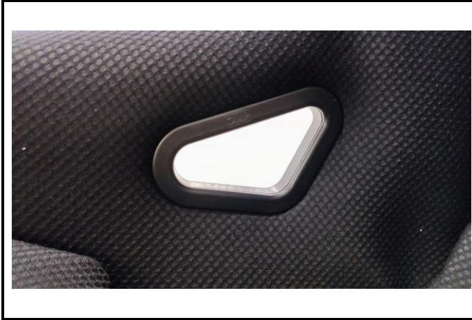
A7) Protection des bords des ouvertures - entrejambe / Slot edge cover-crotch
