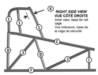
When this design is used for the inner structure, adjacent to the driver, then the outer structure has no minimum requirements. Lorsque cette conception est utilisée pour la structure interne, adjacente au pilote, la structure extérieure n'est soumise à aucune exigence minimale.
