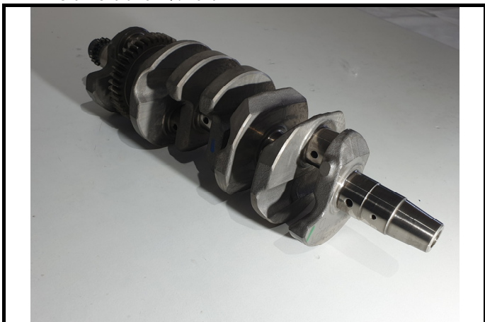
C6-1) Vilebrequin de \frac{3}{4} avant Crankshaft from \frac{3}{4} front
