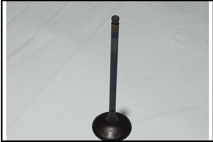
C11-5) Soupape admission - déposée Intake valve - dismantled
