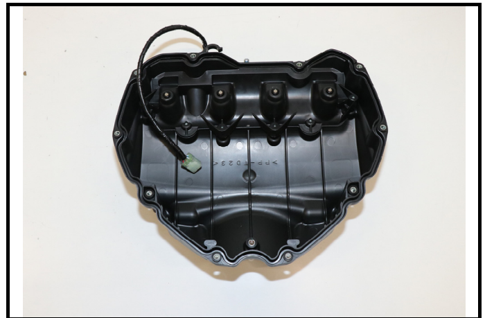
C11-4) Boitier papillon - déposé Throttle unit - dismounted
