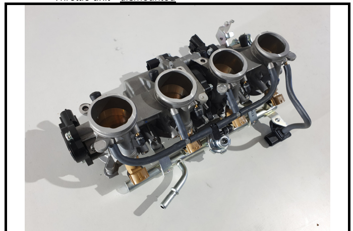
C11-4) Boitier papillon - déposé Throttle unit - dismounted
