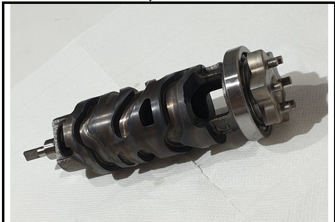
F9-5) Assemblage du barillet Selector barrel assembly
