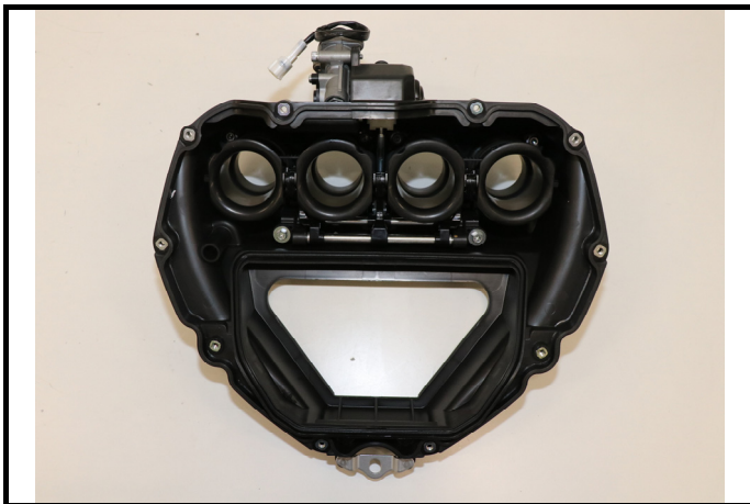
C11-3) Boitier papillon - déposé Throttle unit - dismounted
