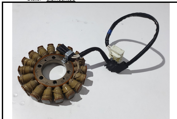
C15-2) Stator - déposé Stator - dismounted
