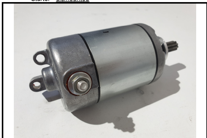
C16-1) Démarreur - déposé Starter - dismounted
