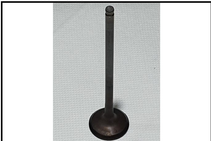
C12-1) Soupape échappement - déposée Exhaust valve - dismantled
