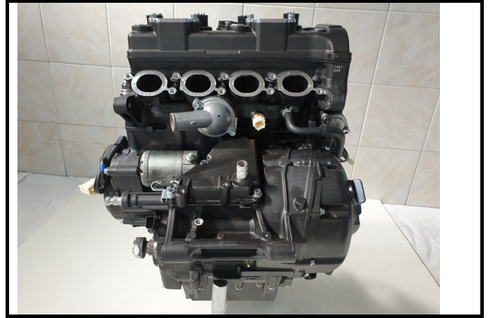
C1-4) Couvre culasse - déposé Cylinderhead cover - dismounted
