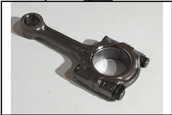
C5-1) Bielle de \frac{3}{4} côté tête Connecting rod from \frac{3}{4} on big end side
