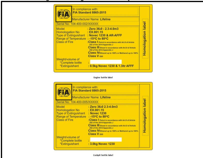
D1-1) Etiquette d'homologation collée sur le corps Homologation label glued on the body
