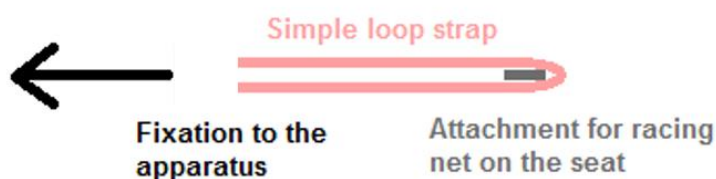
Figure F1. Boucle simple à utiliser pour fixer la sangle représentative à la fixation pour filet de course sur le siège
