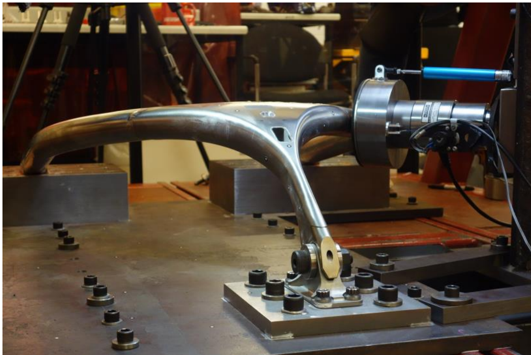
Figure C5. Exemple d'équipement d'essai pour l'Essai statique 2 (vue de face) Figure C5. Example of test equipment for Static Test 2 (Front View)
